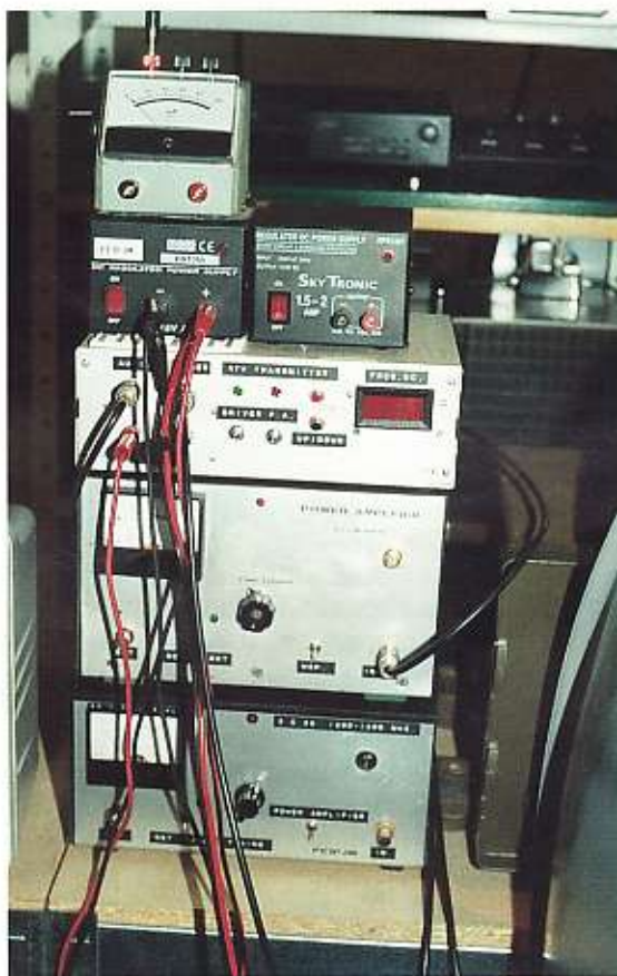
Van boven naar beneden: vieldsterktemeter, laagspanningsvoeding, 23 cm. ATV-zender en twee eindtrappen met de buizen 2C39 met ingebouwde voeding.
